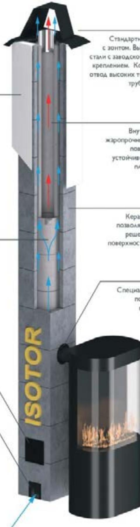
Стандартный фирменный оголовок с зонтом. Выполнен из нержавеющей стали с заводской покраской и надежным креплением. Конструкция обеспечивает отвод высоких температур от внутренней трубы дымоходной системы.
